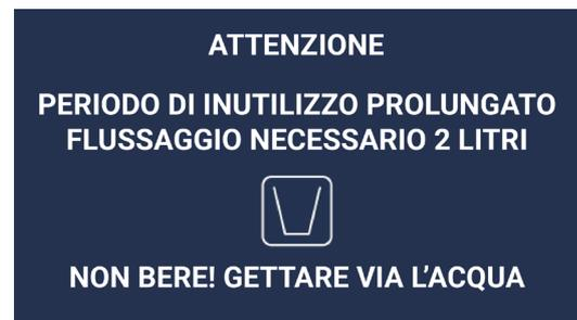
**31.13** – Dopo un periodo di inutilizzo superiore a 15 giorni, l'erogatore richiede un flussaggio di circa 10 litri per garantire l'efficienza del filtro. Tenere premuto il tasto d'erogazione finché il messaggio sparisce.
