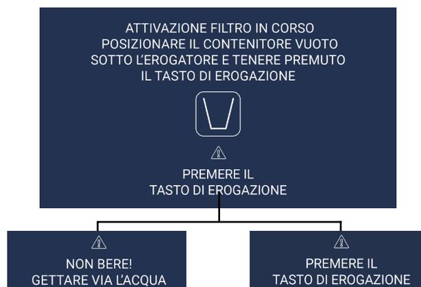
**⚠ ATTENZIONE PERICOLO:** non bere, gettare via l'acqua erogata in questa fase, **non utilizzare l'acqua erogata per qualsiasi altro uso.** È da ritenersi normale la presenza di carbone attivo in questa fase di attivazione, gettare via l'acqua erogata.
