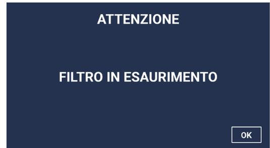
**31.2** – Quando il filtro è esaurito; dopo 15.000 litri, 12 mesi di utilizzo, o 8 settimane di inutilizzo, toccando un qualsiasi tasto di erogazione sul display verrà visualizzato il messaggio **“SOSTITUIRE FILTRO ESAURITO”** cambiare il filtro il prima possibile, rischio di elevata carica batterica. Si manifesta l'esigenza di sanificare l'erogatore.
