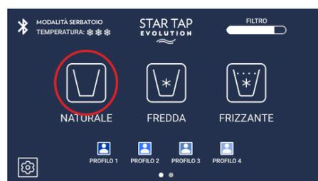
In alcuni casi, data la presenza d'aria, il contaltri all'interno dell'erogatore può non rilevare il flusso di acqua all'interno del circuito, nel caso la macchina segnali la mancanza di acqua, effettuare il reset dell'allarme premendo il tasto RESET e procedere con l'erogazione dell'acqua naturale finché il flusso non venga ristabilito.
