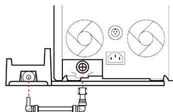
Il raccordo di allacciamento idrico dell'apparecchio è situato alla base del lato posteriore, nell'apposito vano allacciamenti. Inserire il raccordo femmina (lato macchina) al maschio già collegato alla valvola di carico dell'erogatore.
