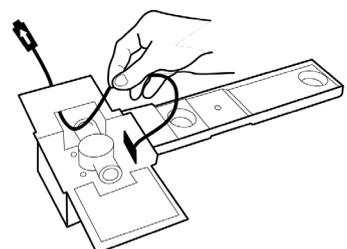
Inserire il tubo flessibile 3/8" nel raccordo femmina della base, inserire l'altra estremità nel raccordo 90° fino al punto di blocco. Inserire l'altro lato del raccordo a 90° nel raccordo femmina (lato serbatoio). Nel lato opposto della valvola, inserire il tappo 3/8" premendo fino al punto di blocco. In caso di montaggio sul lato destro si consiglia l'inserimento del secondo raccordo 90° tra il tubo flessibile 3/8" e il raccordo femmina della base.
