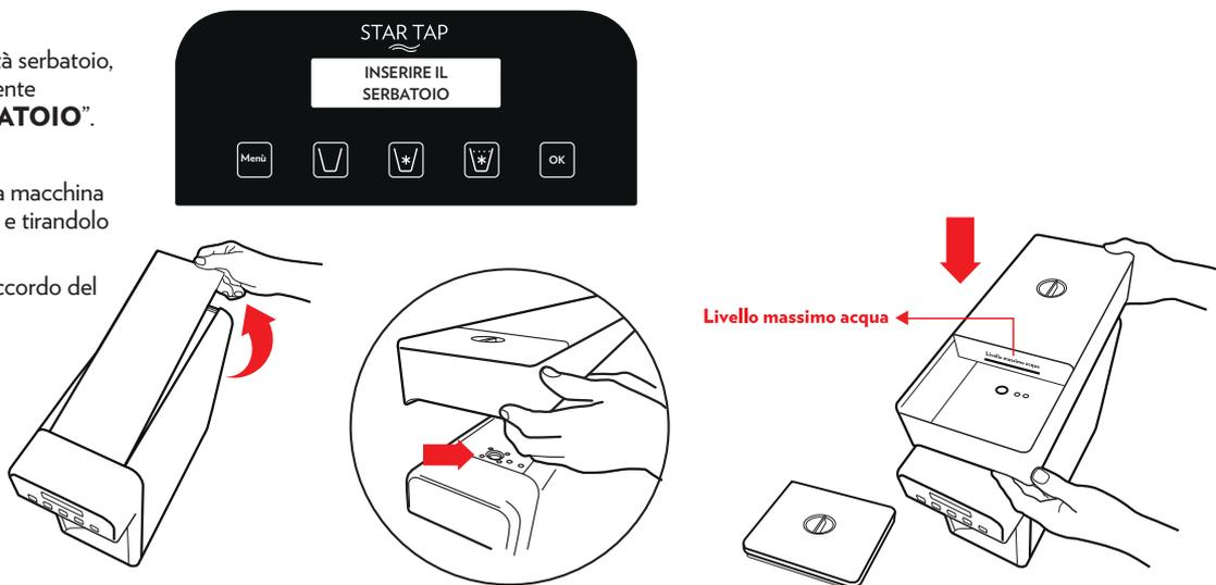
Inserire il serbatoio nella propria sede; verrà visualizzato il seguente messaggio: **“RIEMPIRE SERBATOIO OK”.**
