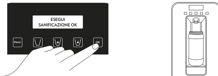
Premere e mantenere premuto il tasto illuminato dell'acqua ambiente, verranno visualizzati i tre messaggi a lato in modo alternato. Erogare acqua fino a quando apparirà il seguente messaggio: **“SANIFICAZIONE IN CORSO 20 MIN”**, si udiranno 3 beep. Il flusso può presentarsi irregolare. Si consiglia di avvicinare il contenitore all'ugello di erogazione. Attendere il tempo necessario per la sanificazione (circa 20 minuti).
